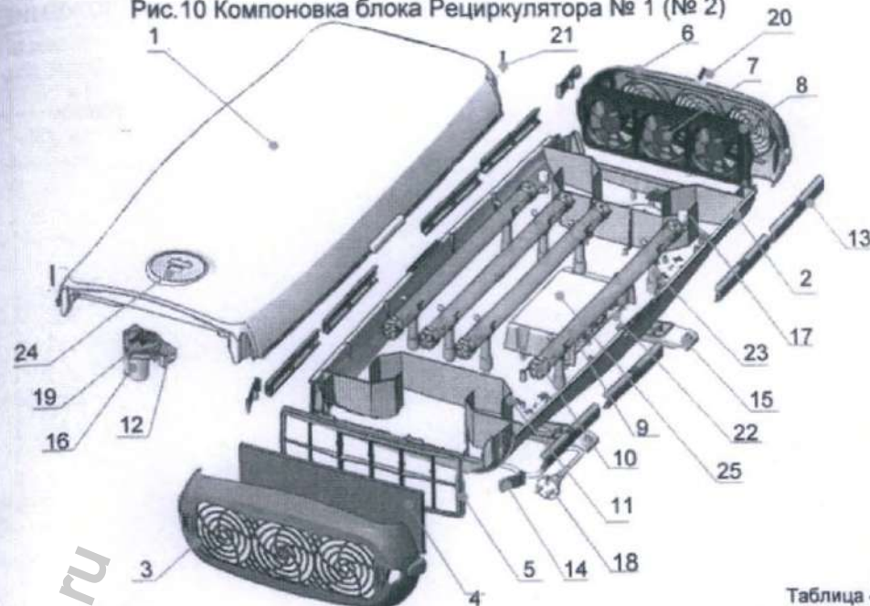
Рис.10 Компоновка блока Рециркулятора № 1 (№ 2)
